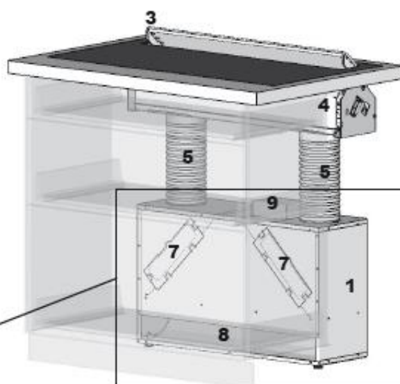
Blok silnika wyciągu kuchennego w trybie recyrkulacji
