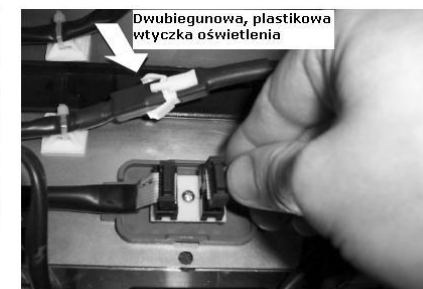
Rys. 25 ...wpiąć wtyczkę sterowania w gniazdko...
