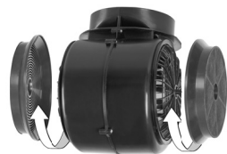
Montaż filtrów węglowych do turbiny
