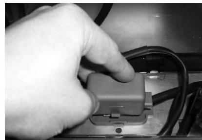
Rys. 26 ...założyć i zapiąć skrzynkę połączeń...
