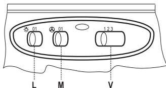
**L** Освещение Включает и выключает осветительное оборудование
